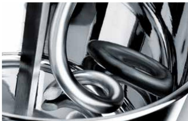
Pale à spirale et barre brise-pétrissage pour une meilleure homogénéité du pétrin et sa parfaite oxygénation
